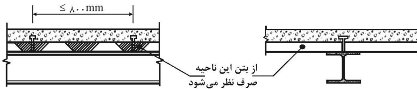
شکل ۲-۱۰-۸-۵ ورق‌های فولادی شکل داده شده که کنگره‌های آنها عمود بر محور تیر می‌باشد
